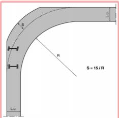
Les voies en impasse ouvertes à la circulation automobile doivent être aménagées de façon à permettre aux véhicules de faire un demi-tour en trois manœuvres au plus, conformément aux schémas suivants :
